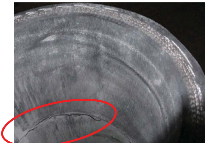
先端ホース内側の ワイヤ近くのゴムのはがれ
