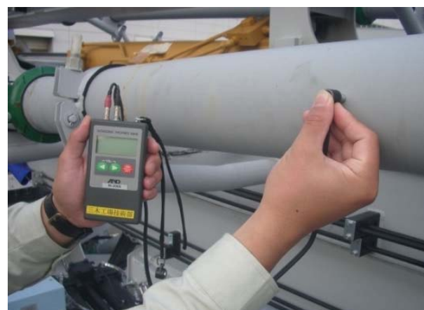
輸送管の肉厚計測の様子
