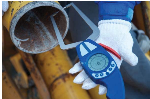
輸送管の肉厚計測の様子
