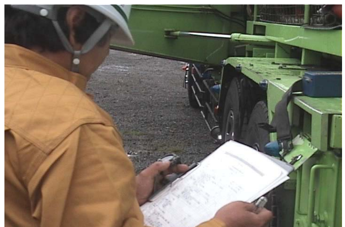
ストップウォッチによるピストンのストローク数の計測の様子
