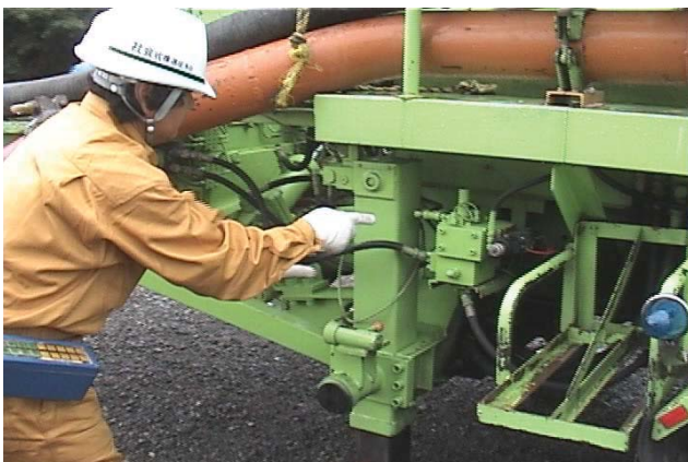
油圧ホース類の点検の様子
