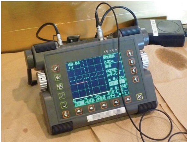
超音波探傷器の例
