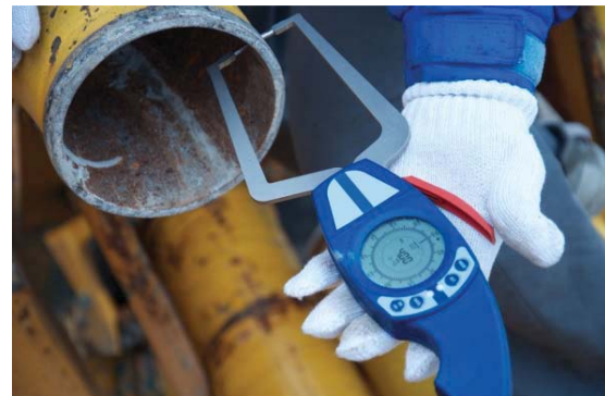
外パス(デジタル式)の例と輸送管の肉厚計測の様子
