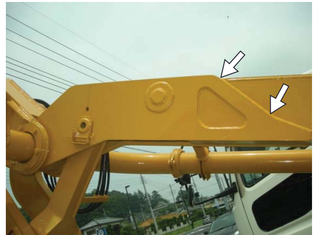
ブーム溶接部の点検・検査箇所の例
