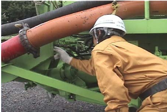
アジテータ(かくはん)装置のモーターからの油もれの有無の点検の様子
