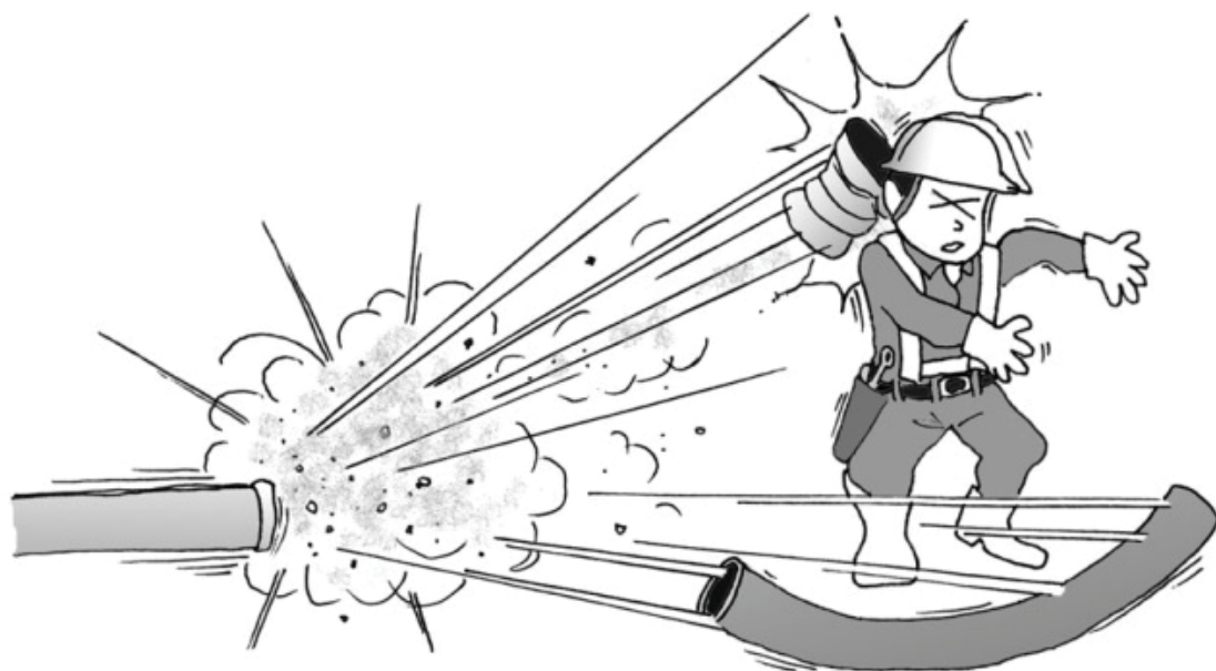
空気洗浄中の圧縮空気の爆発現象による事故例
