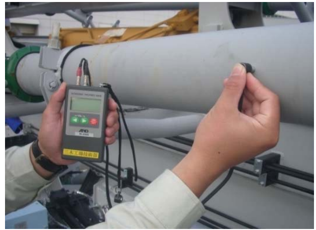
超音波厚さ計で輸送管の肉厚を点検する様子
