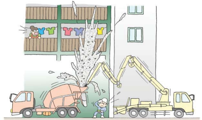
トラックアジテータ(生コン車)への返送中のコンクリート飛散事故の例
