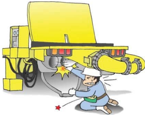
動き出したSパイプに手指を挟まれた事故例
