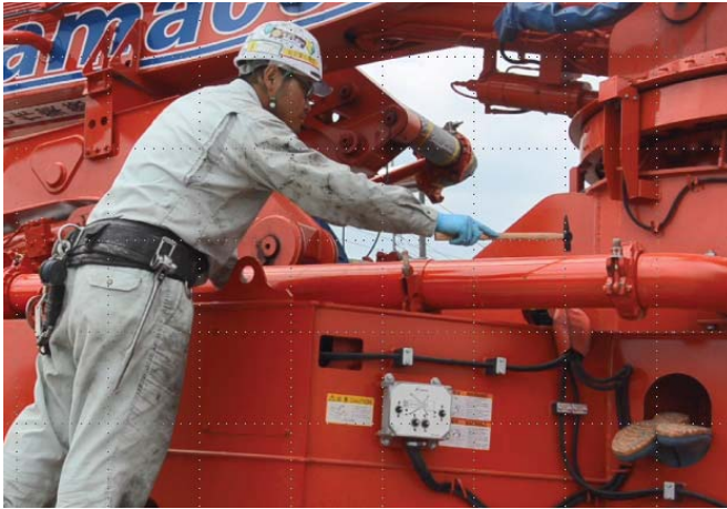
打音で輸送管の肉厚を点検する様子
